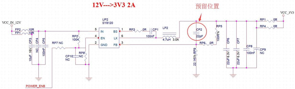
图 10 DC-DC 降压电路
