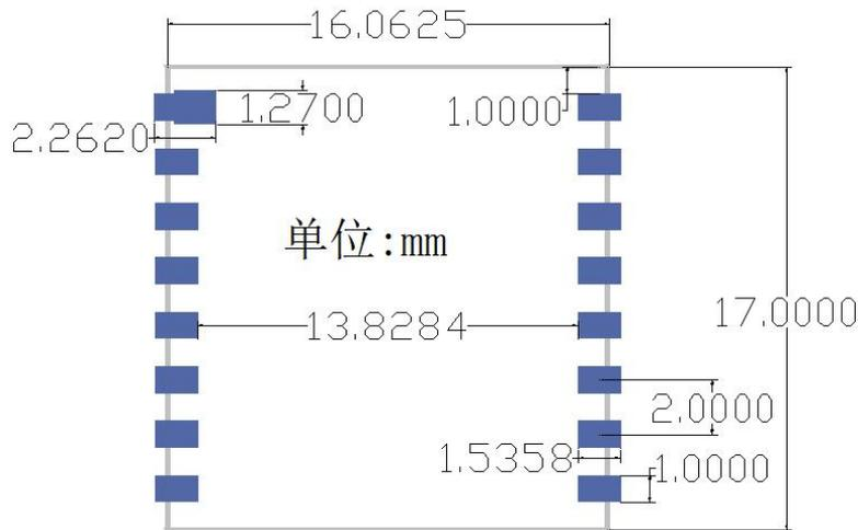
图 9 推荐 PCB 封装尺寸图
